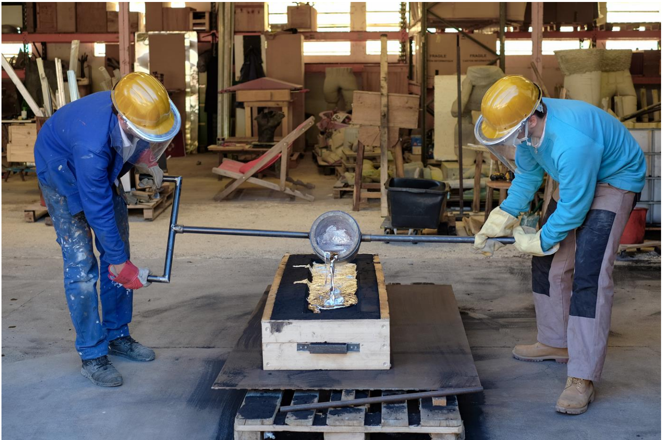
Paul F. Millet coule avec l'aide d'un bénévole de l'association de l'aluminium en fusion dans un moule en sable, afin d'en saisir l'empreinte © VdF
