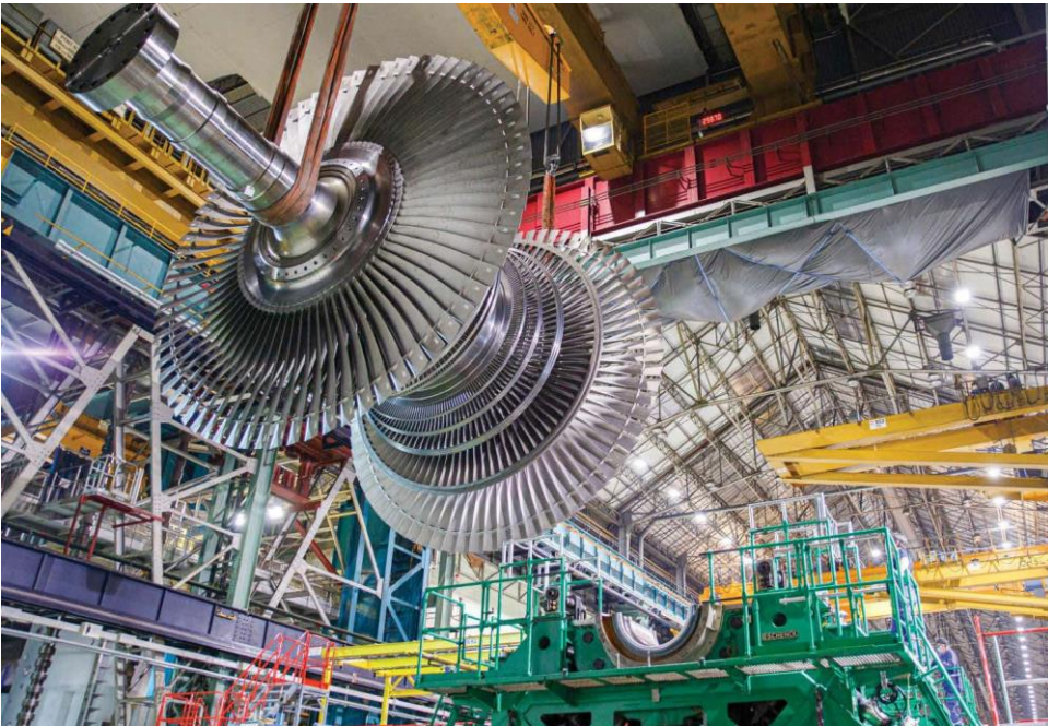
Turbines Arabelle, destinée à transformer la chaleur d'un réacteur nucléaire en force mécanique puis en électricité.
